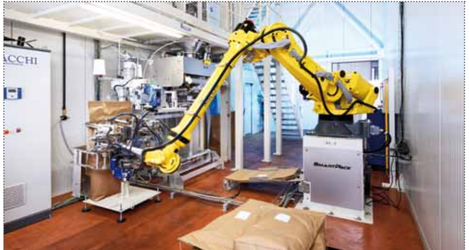
Der Abpackroboter hilft den Mitarbeitenden nicht nur beim Dosieren und Abfüllen der Ware, sondern besonders auch beim Palettieren, der bis zu 25 kg schweren Säcke.
