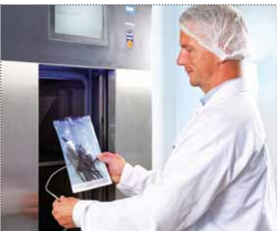
In der Pilotanlage werden die Entkeimungsparameter für jedes Produkt aufeinander abgestimmt.
