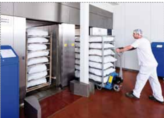
Zwei neue Autoklaven ermöglichen größere Mengenkapazitäten und schnellere Durchlaufzeiten.
